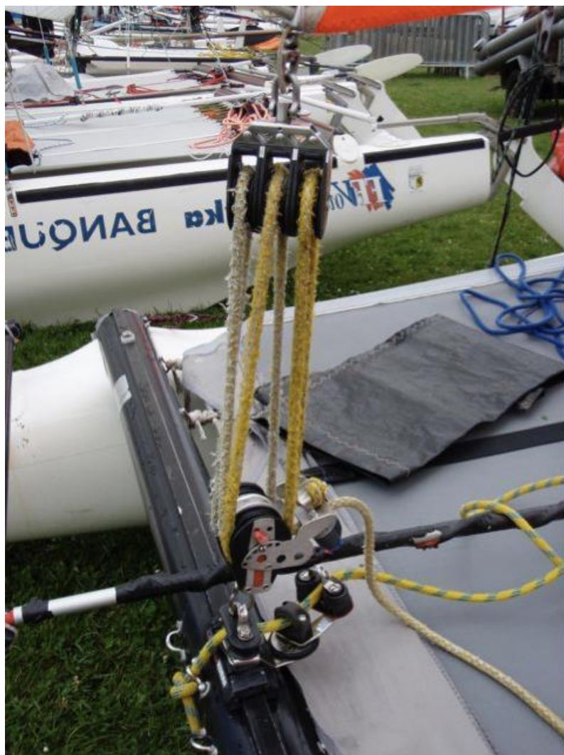
Détail du palan de GV
