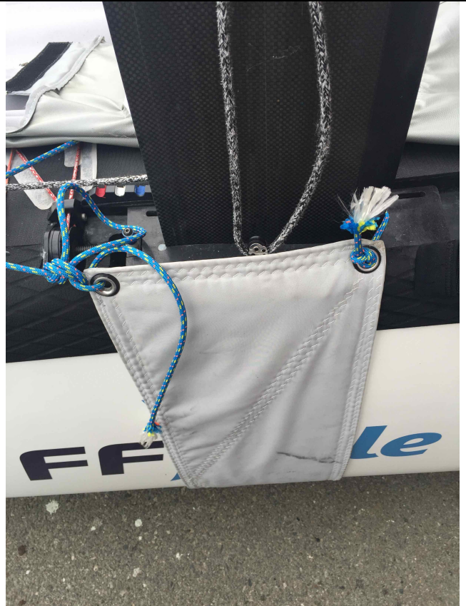
Une partie remonte le long du bordé et se fixe au pont
