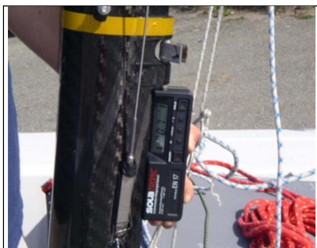
Inclinomètre positionné sur mât
